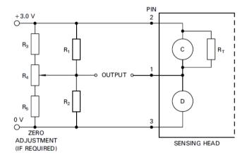
$R_1 \,=\, R_2 \,=\, 500 \Omega$  to 10  $k\Omega$
