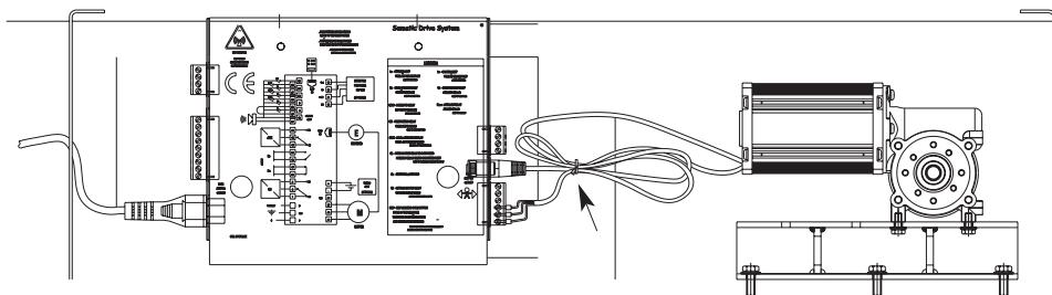
*Hinweis: bei Austausch des Motors sind die Kabel wie oben angegeben zu befestigen, damit der Kontakt der Kabel mit dem Antriebsriemen verhindert wird.*
