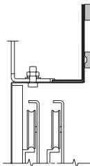
Ein von Sematic auf dem Kabinettürantrieb befestigter Magnetschalter wird an die Klemmen 15-40 angegeschlossen und durch Magneten gesteuert (Option) die auf den Schachttüren montiert sind, die zur Notöffnung vorgesehen sind. Dies erfolgt über vorgesehene Hilfswinkel (siehe Zeichnung).
