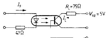
$I_f=10$  mA,  $V_{op}=5$  V,  $T_{amb}=25^\circ\text{C}$
