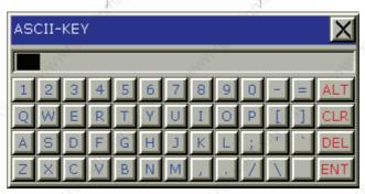
Fig. 3.10.3 ASCII-KEY input dialog box
