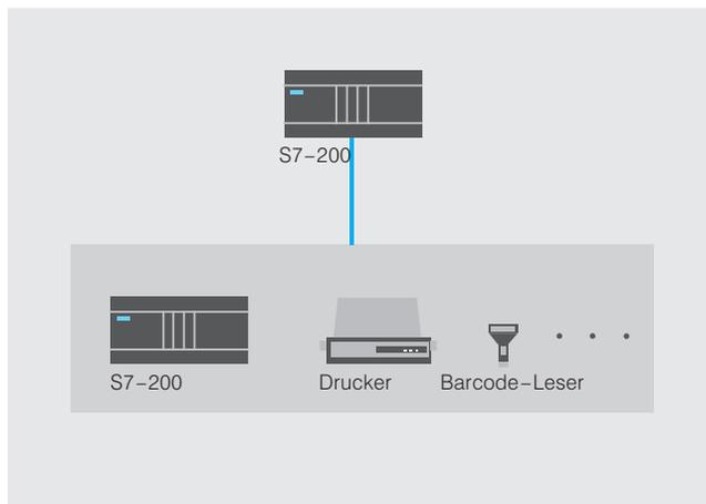
Bild 1/2 Kommunikation im frei programmierbaren Schnittstellenmodus
