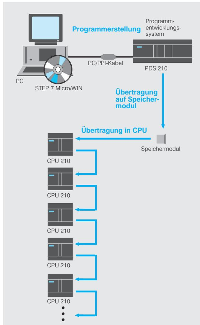
Bild 1/6 Programmierung und Programmduplizierung bei der CPU 210
