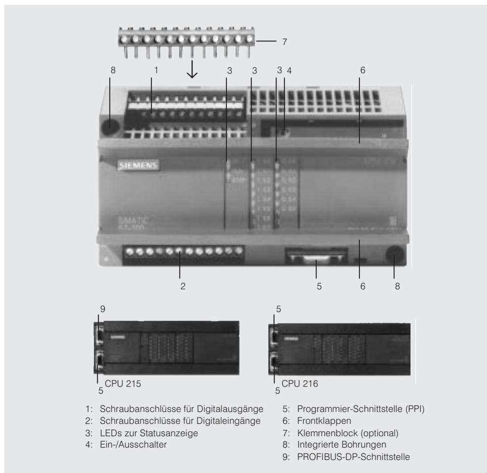
Bild 1/5 Aufbau der SIMATIC S7-200 (CPU 212)
