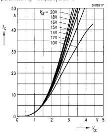
Typ. output characteristics  $I_{\rm C} = f(V_{\rm CE})$  parameter:  $t_{\rm p} = 80~\mu \rm s$ ,  $T_{\rm i} \le 125~{\rm ^{\circ}C}$
