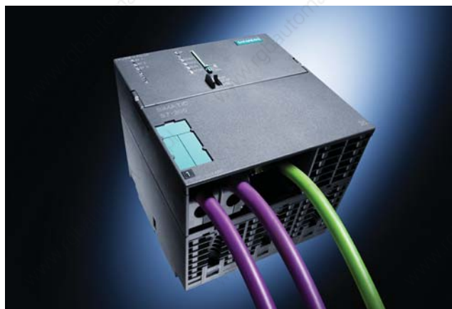
Super szybki CPU 319-3 PNI/DP z interfejsem PROFINET
