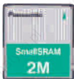
IC memory card 2MB SRAM
