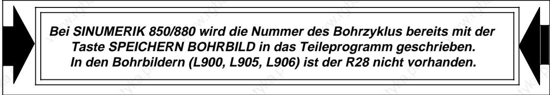
*Bei SINUMERIK 850/880 wird die Nummer des Bohrzyklus bereits mit der Taste **SPEICHERN BOHRBILD** in das Teileprogramm geschrieben. In den Bohrbildern (L900, L905, L906) ist der R28 nicht vorhanden.*
