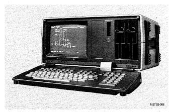
Bild 6/5 Programmiergerät PG 675
