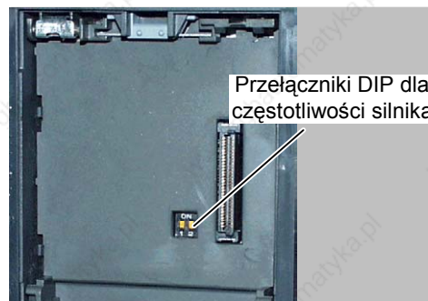
Rys. 3-4 Przełączniki DIP do wyboru częstotliwości silnika
