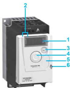
ATV 12H075M2 z zamkniętym panelem przednim i z pokrywą zabezpieczającą 5: dostęp do przycisków STOP/RESET i RUN
