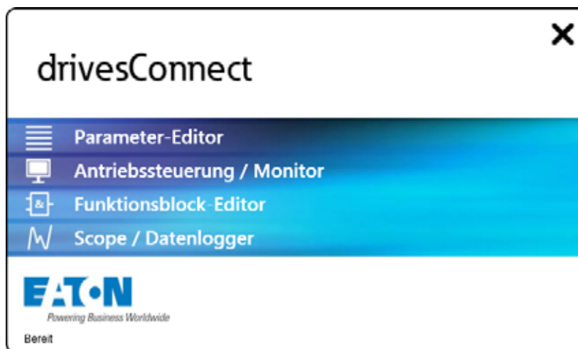
Ilustracja 60: Główne moduły drivesConnect w oknie startowym
