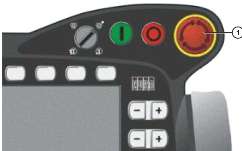
Rys. 4-2: Przycisk WYŁĄCZENIA AWARYJNEGO na KCP
