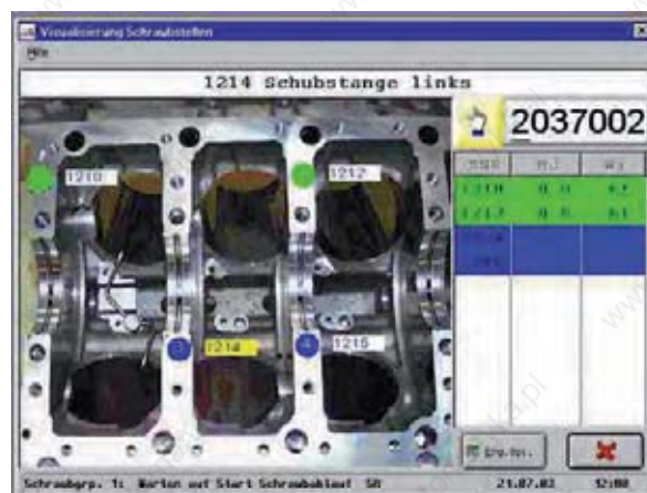
Visualisierung mit Hintergrundbild am m-Pro-400S/SE Bildschirm Visualization with background image on m-Pro-400S/SE screen
