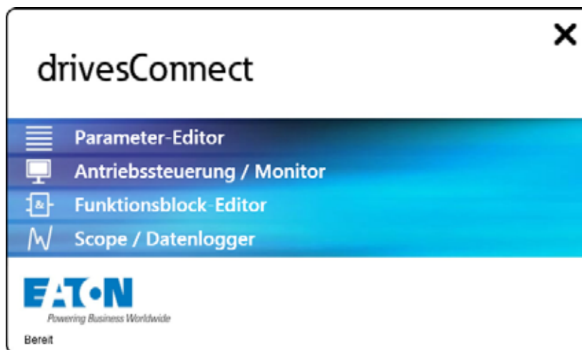
Ilustracja 60: Główne moduły drivesConnect w oknie startowym
