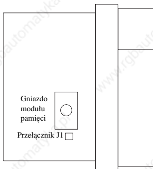
Widok strony bocznej modułu procesora 1747-L524 Seria C
