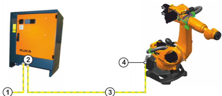
Fig. 4-18: Equipotential bonding, robot controller - manipulator
