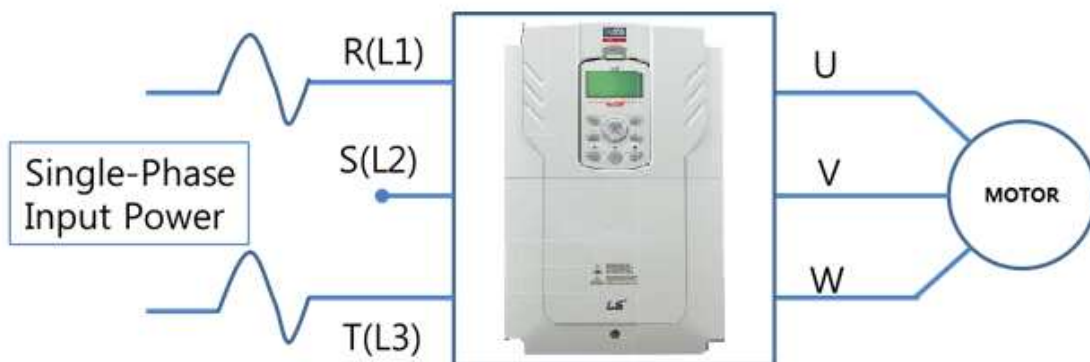
Rysunek-3 Kablowanie jednofazowego zasilania.
