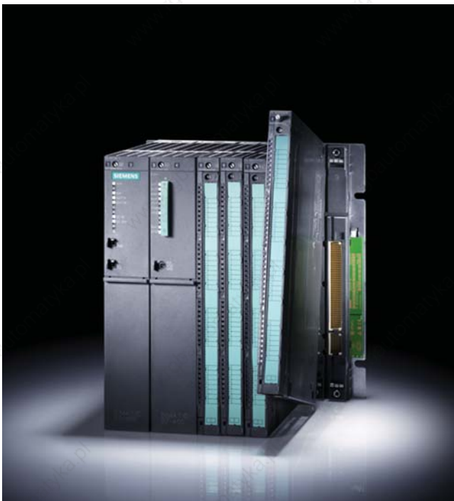
Moduły I/O SIMATIC S7-400 można wyjmować pod napięciem
