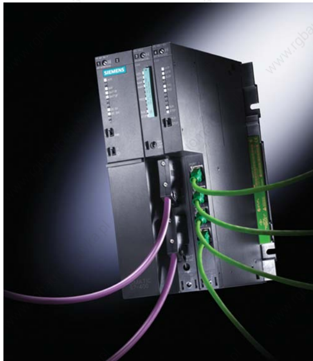
SIMATIC S7-400 z procesorem komunikacyjnym PROFINET
